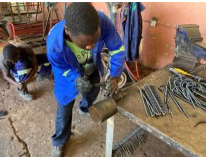
Oben: Die Erstellung der 1600 Befestigungshaken. Unten: das Wellblech für das neue Dach.
