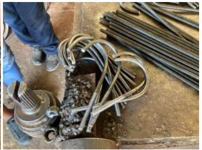
Oben: Die Erstellung der 1600 Befestigungshaken. Unten: das Wellblech für das neue Dach.
